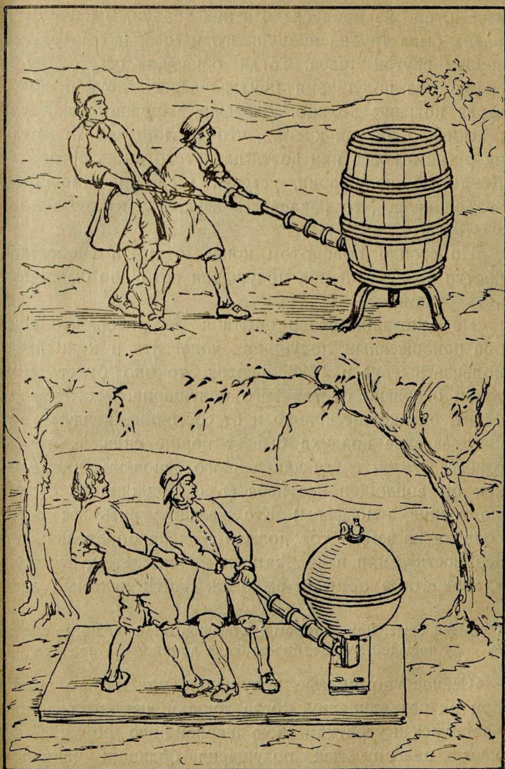
Рис. 64. Первый и второй опыты Отто Герике над образованием безвоздушного пространства.
