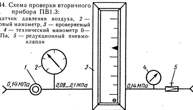
В проверочной схеме для прибора ПВ1.3 (рис. 144) для имитации пропорционального пневмосигнала и подачи питания целесообразно использовать пневмостенд ЛТ-40. Входной сигнал и его изменения контролируют по образцовому манометру 2 и изменяют задатчиком 1 стенда. Питание подводится к штуцеру «Пит.» прибора 3, а имитируемое давление подается на штуцер «Переменная». Задатчиком 1 стрелку прибора устанавливают на оцифрованные точки шкалы, соответствующие 0; 20; 40; ...; 100 %.
