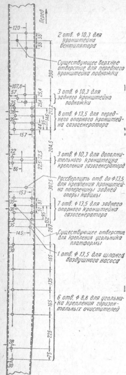
Рис. 9. Разметка отверстий на правом лонжероне рамы автомобиля
