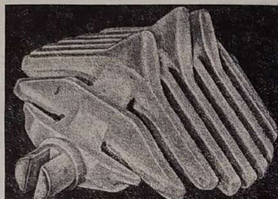
Рис. 4. Крышеобразная качающаяся колосниковая решетка газогенератора АГ для торфобрикетов.
