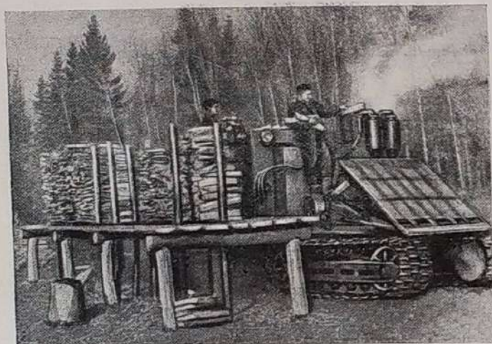
Рис. 8. Момент загрузки топлива в газогенератор ЦНИИМЭ-17 на лесосеке.
