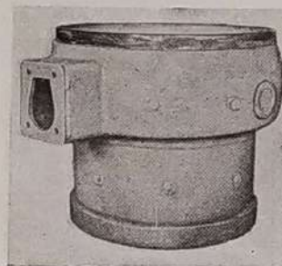
Рис. 10. Камера газификации газогенераторного трактора НАТИ.
