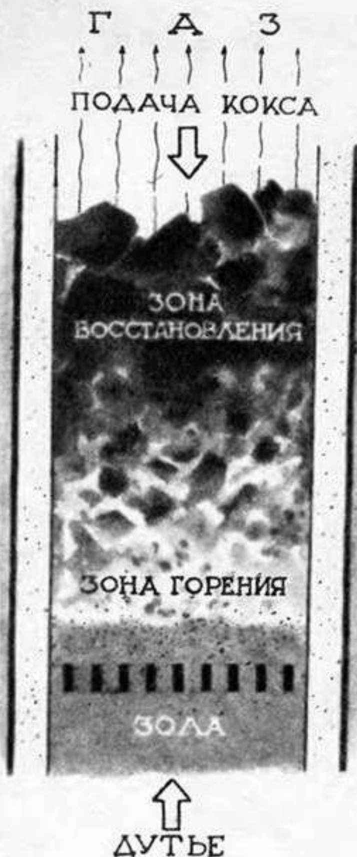
Схема обычного газогенератора. Внизу, на колосниках, происходит горение; образующаяся углекислота, поднимаясь через верхние слои раскаленного кокса, соединяется с ним и дает горючую окись углерода.
