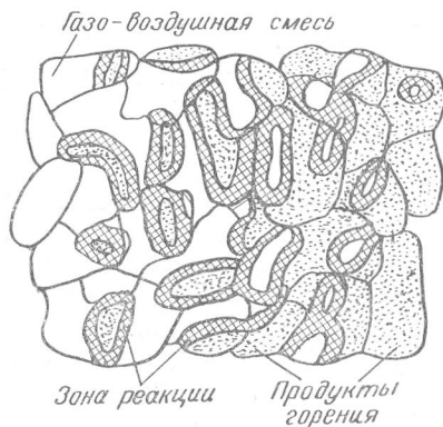
Рис. 3-5. Модель «фронтального» турбулентного горения.
