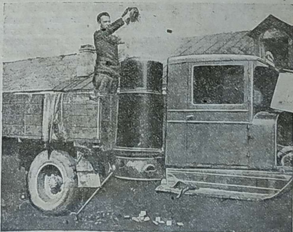
Заправка газогенератора дровами — внизу на земле видны размеры чурок
