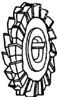
Фиг. 72. Смещение зубьев фрезы для равномерности фрезерования.
