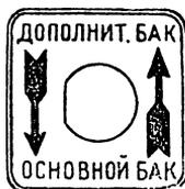
Рис. 5. Положение рукоятки переключателя реостата указателя уровня бензина
