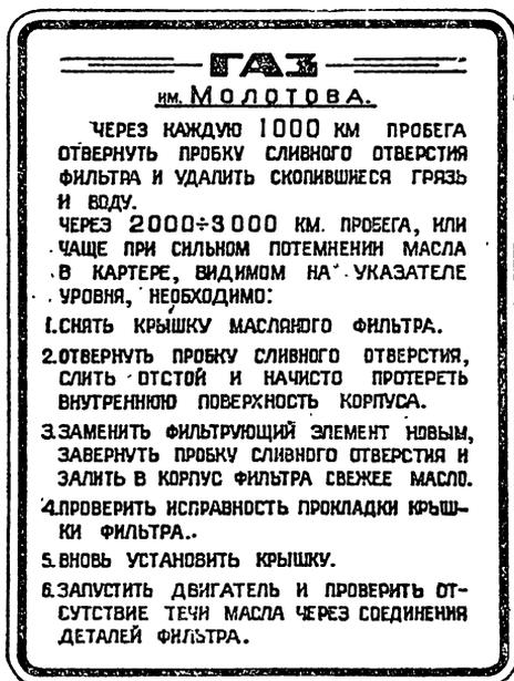
Рис. 9. Инструкционная табличка масляного фильтра тонкой очистки
