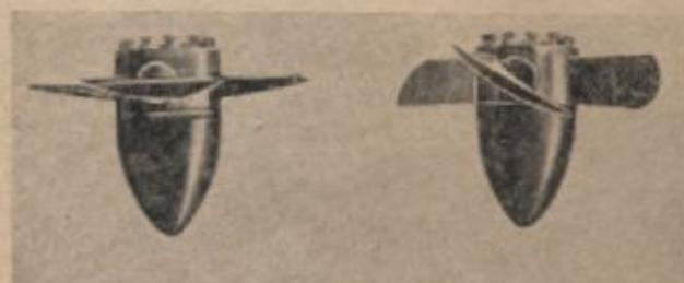
Фиг. 15. Рабочее колесо турбины с поворотными рабочими лопастями в нерабочем и рабочем положениях лопастей.
