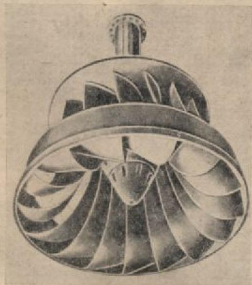
Фиг. 3. Рабочее колесо реактивной радиально-осевой турбины.
