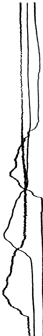
Фиг. 114. Осциллограмма эюры распределения нагрузки по длине зацепления ( A = 150 м; i = 37 ; n_1 = 1000 об/мин; N_1 = 7,5 л. с.).
