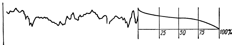
Фиг. 129. Профилограмма и кривая опорных площадей для шлифованной поверхности.
